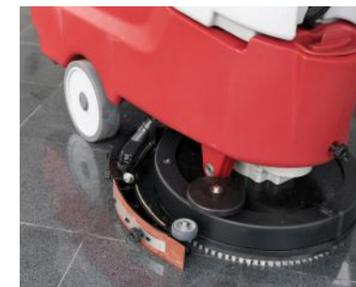
Saugbalken schwenkt automatisch in die Arbeitsrichtung.
