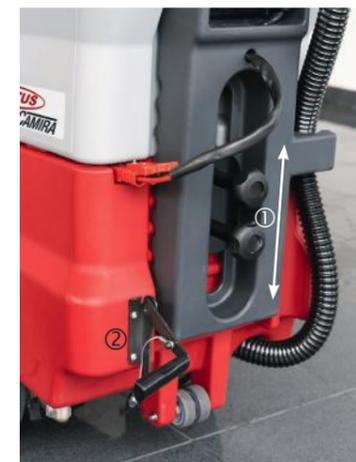
① Die Arbeitshöhe der Bedieneinheit kann individuell eingestellt werden.
